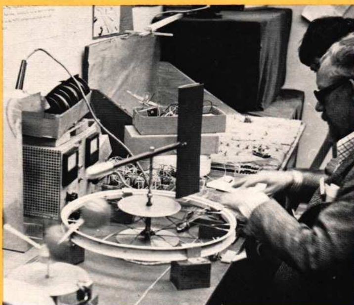
Een met eenvoudige middelen, maar perfect werkend compleet weerstation op de Doe Markt van de DJO. Het bestaat uit een anemometer, ofwel windsnelheidsmeter, regenmeter, temperatuurmeter, zonneshijnmeter en windwijzer. Het een en ander werkt, elektronisch, met op afstand afleesbare gegevensverwerking.
